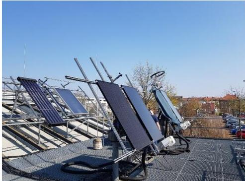
Eine leicht zugängliche Flachdachfläche von 450 m<sup>2</sup> an der htw saar mit verschiedenen Aufständersystemen bietet zahlreiche Möglichkeiten der messtechnischen Ausstattung von Solarthermie-, Photovoltaik- oder PVT-Modulen auf festen (im Neigungswinkel von 30° und 45°) und zweiachsig nachführbaren Solartrackern (für je bis zu 2 Module). Ebenso ist die Installation und der Betrieb von kompletten thermischen Solaranlagen zur Trinkwassererwärmung (bis zu 4 parallel) möglich.
