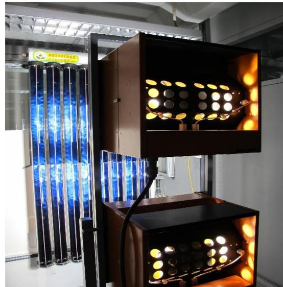
Solarsimulator für PV-Modul bzw. Kollektorflächen bis ca. 2 m<sup>2</sup>
