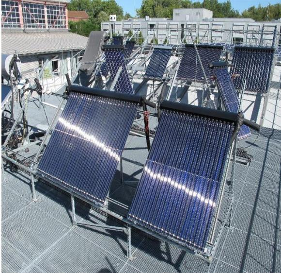
Freifläche zur Untersuchung von thermischen Solarkollektoren, PV-Modulen und PVT-Kollektoren
