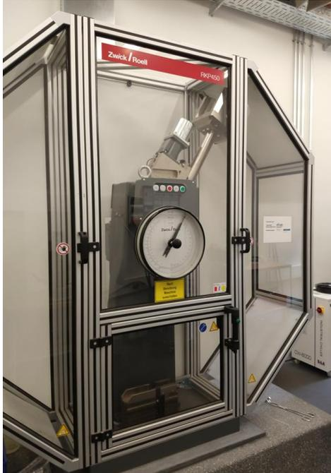
Unser Pendelschlagwerk ist geeignet für schnelle Versuchsdurchführungen (< 5 sec) und Prüfungen an temperierten, speziell an gekühlten (- 40 °C) Proben.
