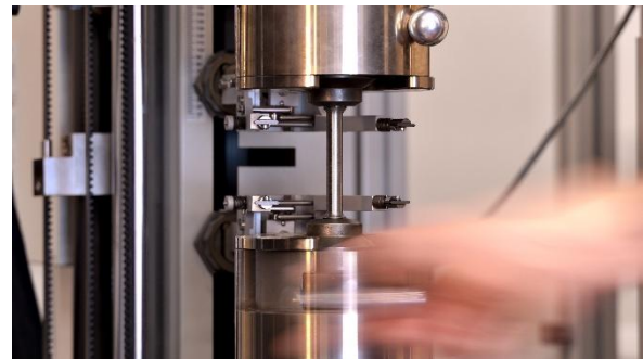
Links: Prüfung von Flachzugproben, rechts: Prüfung von Rundzugproben
