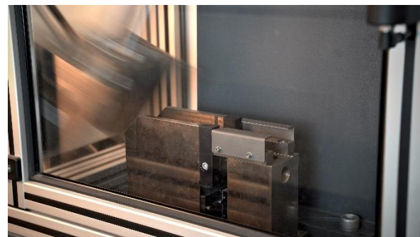
Links: 3-Punkt-Biegeprüfung, rechts: Kerbschlagbiegeprüfung
