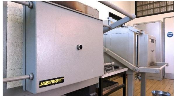
Links: Tiegelschmelzofen, rechts: große Kammeröfen
