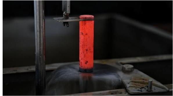
Links: Kleiner Kammerofen mit Rundprobe, rechts: Stirnabschreckversuch
