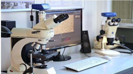
Die Gefügeuntersuchung ist ein Verfahren, das in der Materialwissenschaft und Metallurgie verwendet wird, um die Mikrostruktur von Materialien zu analysieren. Dabei kommen Lichtmikroskope zum Einsatz, um die verschiedenen Phasen, Korngrößen, Einschlüsse und andere Merkmale eines Materials zu untersuchen. Diese Art der Untersuchung ist wichtig, um die Eigenschaften von Materialien zu verstehen, wie z. B. ihre Festigkeit, Zähigkeit und Korrosionsbeständigkeit.
