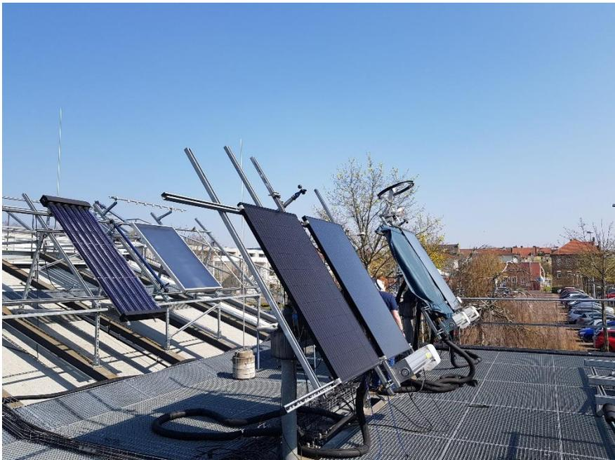
Eine leicht zugängliche Flachdachfläche von 450 m<sup>2</sup> mit verschiedenen Aufständersystemen bietet zahlreiche Möglichkeiten der messtechnischen Ausstattung von Solarthermie-, Photovoltaik- oder PVT-Modulen auf festen (im Neigungswinkel von 30° und 45°) und zweiachsig nachführbaren Solartrackern (für je bis zu 2 Module). Ebenso ist die Installation und der Betrieb von kompletten thermischen Solaranlagen zur Trinkwassererwärmung (bis zu 4 parallel) möglich.
